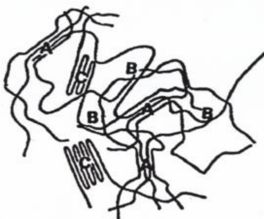
Figure (1) : Représentation des relations entre domaines vitreux et cristallins dans un polymère partiellement cristallin.
