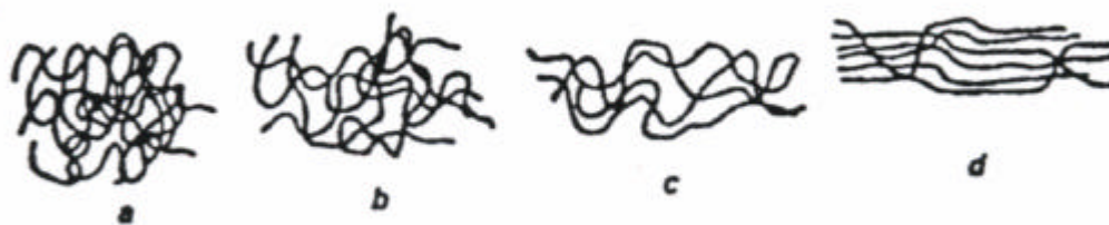
Figure (4) : Influence d'un effort de traction sur la conformation des macromolécules d'un élastomère.(ex : caoutchouc naturel vulcanisé) au repos ; b),c) traction croissante ; d) traction légèrement inférieure à la charge de rupture.
