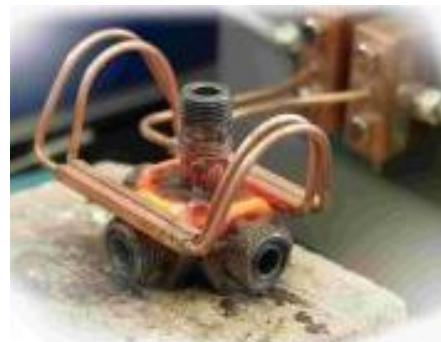
b- Chauffage d'un raccord avec inducteur à tunnel
