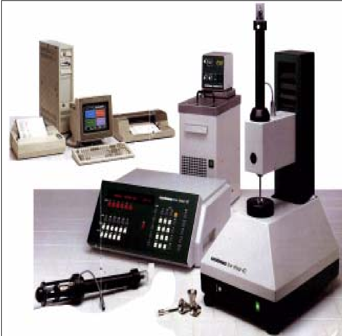
Fig. 4.3 image du rhéomètre low shear 40 et ses accessoires.
