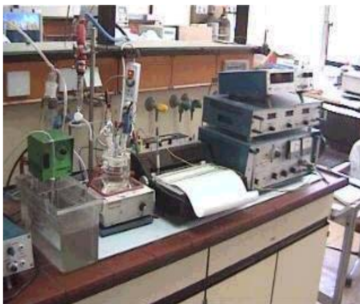
Figure (5) : Photographie de la chaîne électrochimique de corrosion TACUSSEL.
