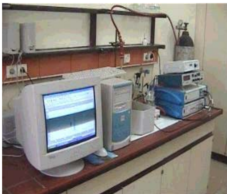
Figure (6) : Photographie de la chaîne électrochimique Voltalab Radiometer Analytical.
