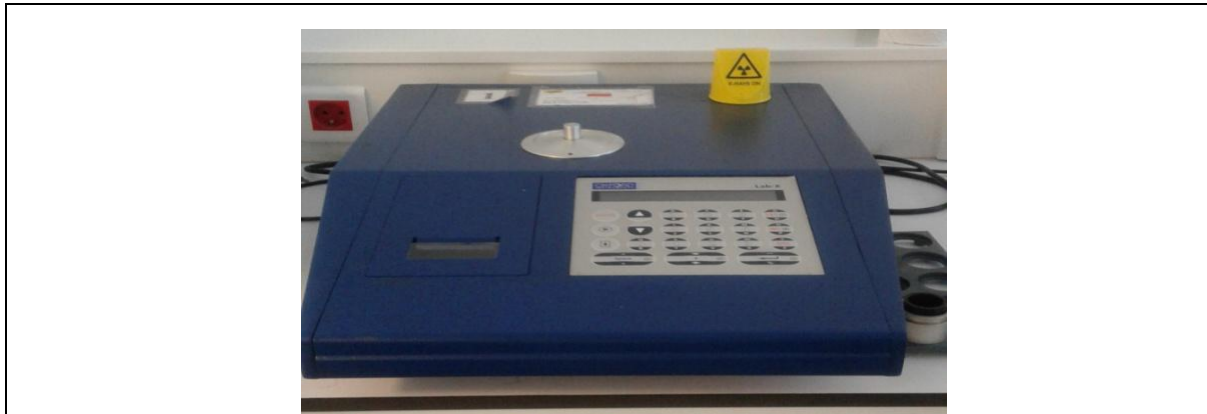
Figure A.4. Analyseur de soufre par radiofréquence (XRF).
