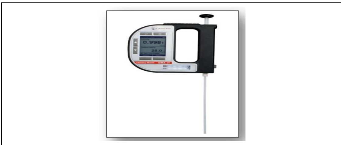
Figure A.1. Densimètre de marque DMA 35.
