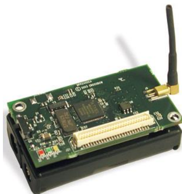
Figure 1.1. Exemple de capteur sans fil MICAZ de Crossbow.
