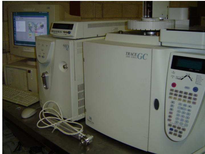
Figure II.5 Chromatographe GC Trace, Thermo Finnigan équipé d'une boucle d'injection à pression atmosphérique et une vanne 6 voies, spécial gaz.
