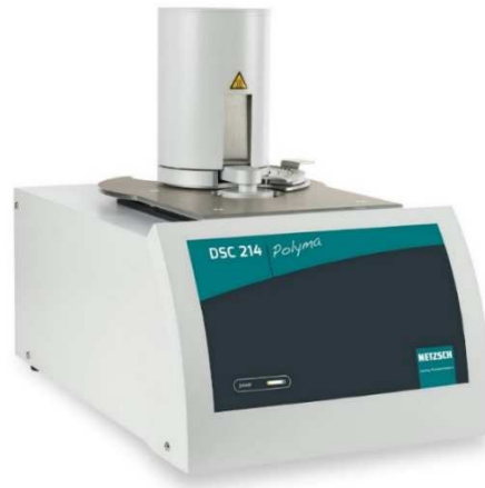
Figure B.03. Appareil utilisé pour la mesure de la chaleur spécifique DSC Polyma 214.
