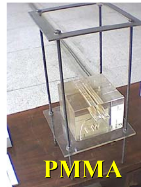
(d) fantôme de PMMA
