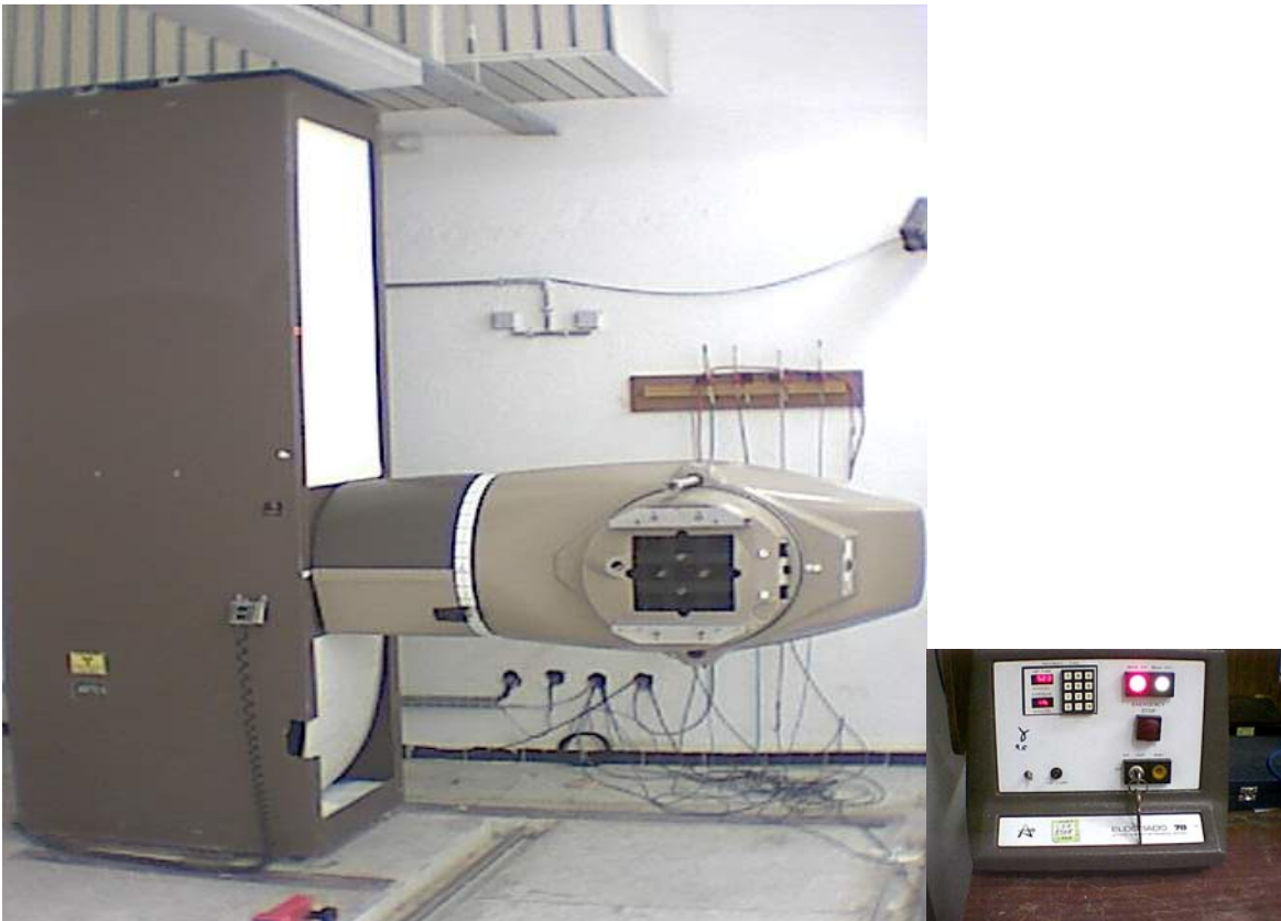
Figure 2.6 : Unité de Cobalt 60 ( ^{60}\text{Co} ) l'ELDORADO78 et sa Console de commande
