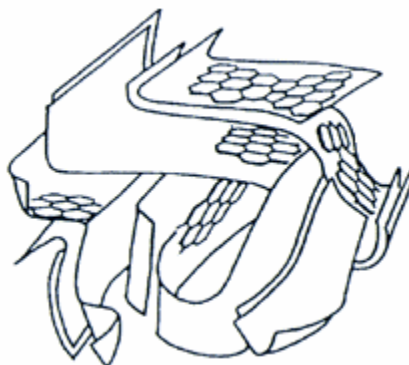
Figure I-1 : Représentation de la structure d'un charbon actif selon Bansal [20].
