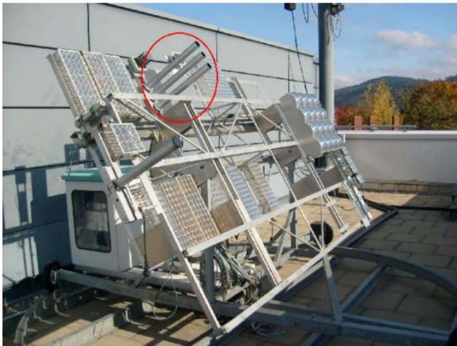
Figure 4.1 : Suiveur à deux axes avec modules CPV et instruments nécessitant le suivi du soleil.
