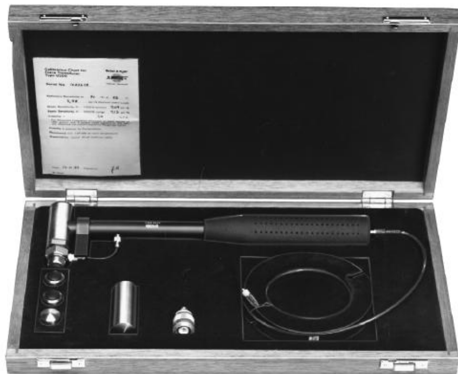
Figure1. Marteau d'impact avec capteur de force
