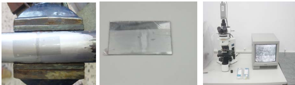
Figure 2 : Prise d'une réplique au niveau d'un joint soudé.
