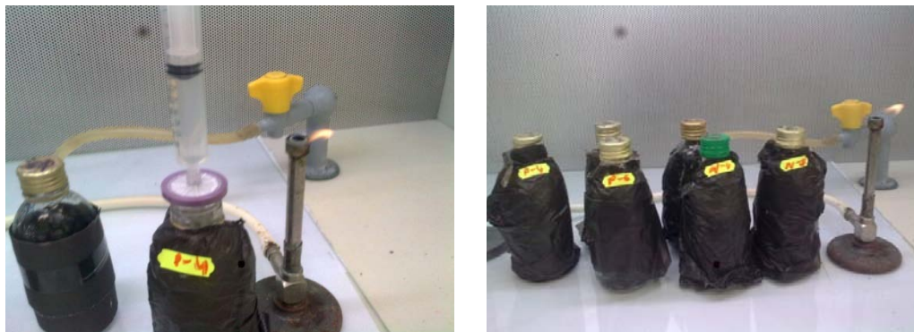
Figure 11. Stérilisation des herbicides par microfiltration (0.22 \mu m) et préservation contre la photolyse.
