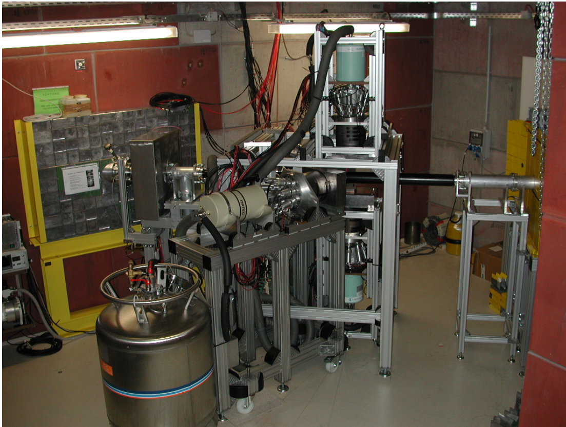
Fig 4.10: Vue des détecteurs entourés de systèmes de suppression Compton, utilisés dans les expériences NRF de ce travail.
