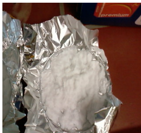
Image 5: Séchage du PAAM une précipitation dans le méthanol.
