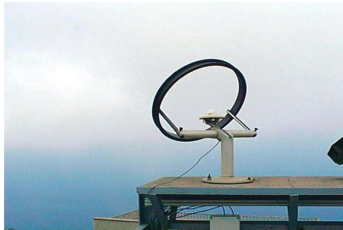
Fig. 4. Pyranomètre muni d'une bande pare soleil: Mesure de la composante diffuse ( Site de Bouzareah).
