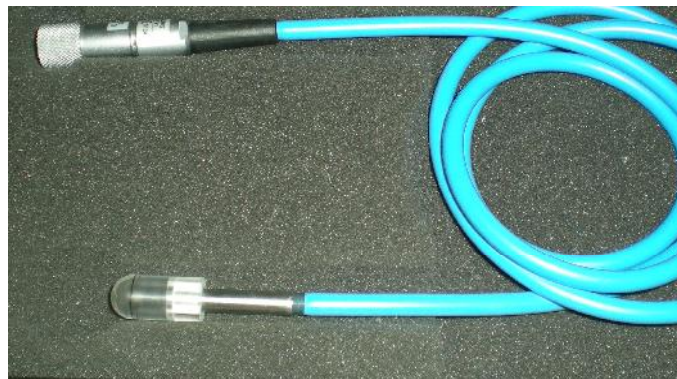
Figure 2.8 : La chambre d'ionisation PTW 31002
