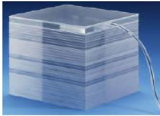
Figure 2.9 : le fantôme solide en plaques, Acrylic Slab Phantom
