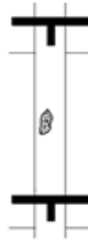
Joint de reprise de bétonnage mise en évidence par un écrasement local du béton dû aux contraintes de compression
