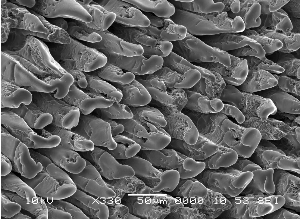
Figure IV.1.3 : Image MEB des micro-colonnes de Si formées par 8000 nombre de tirs laser.
