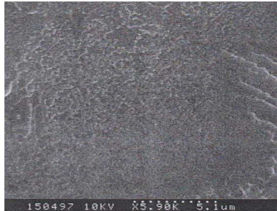
Figure (IV5-10) : Micrographe électronique à balayage du mélange SAM29/ BMV4P26 de rapport 50/50, pour une prise de vue de 5.1 \mu\text{m} .
