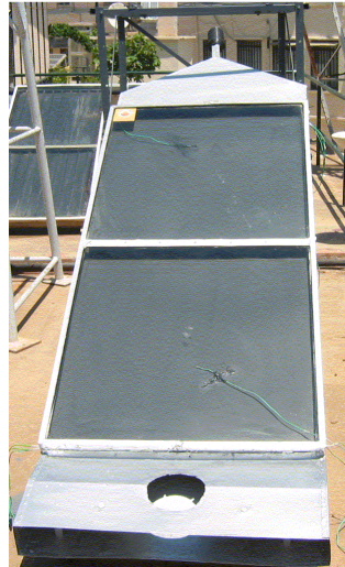
Fig. I.4 Capteur solaire plan à air réalisé au CDER [7].
