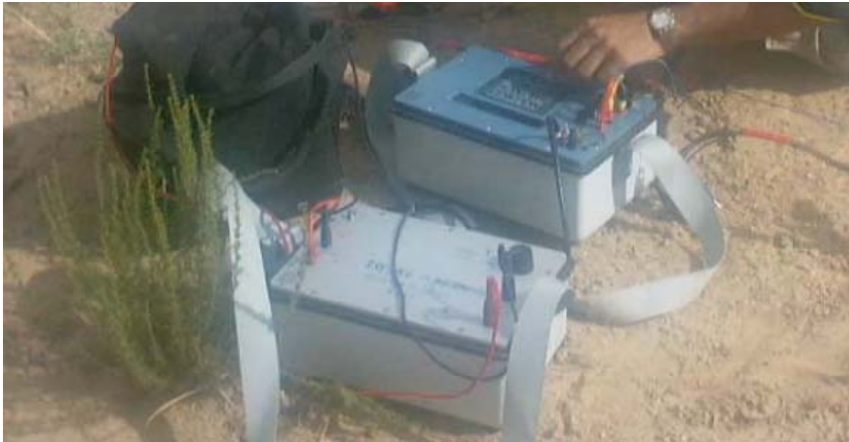
Figure 3.14 : Résistivimètre SyscalR2 et son Convertisseur
