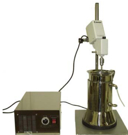
Figure IV.2 : Photo du montage ultrason employée dans cette étude
