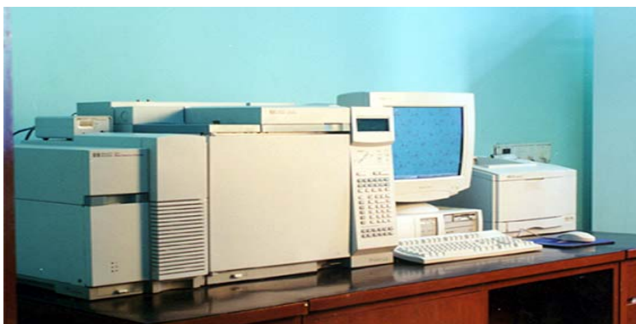
Figure 2-4 : Appareil de chromatographie en phase gazeuse couplé à un spectromètre de masse.
