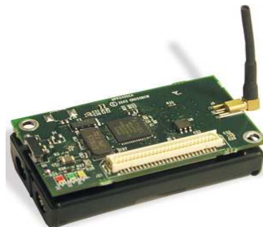
Figure 2. Exemple d'un capteur sans fil MICAZ de Crossbow.
