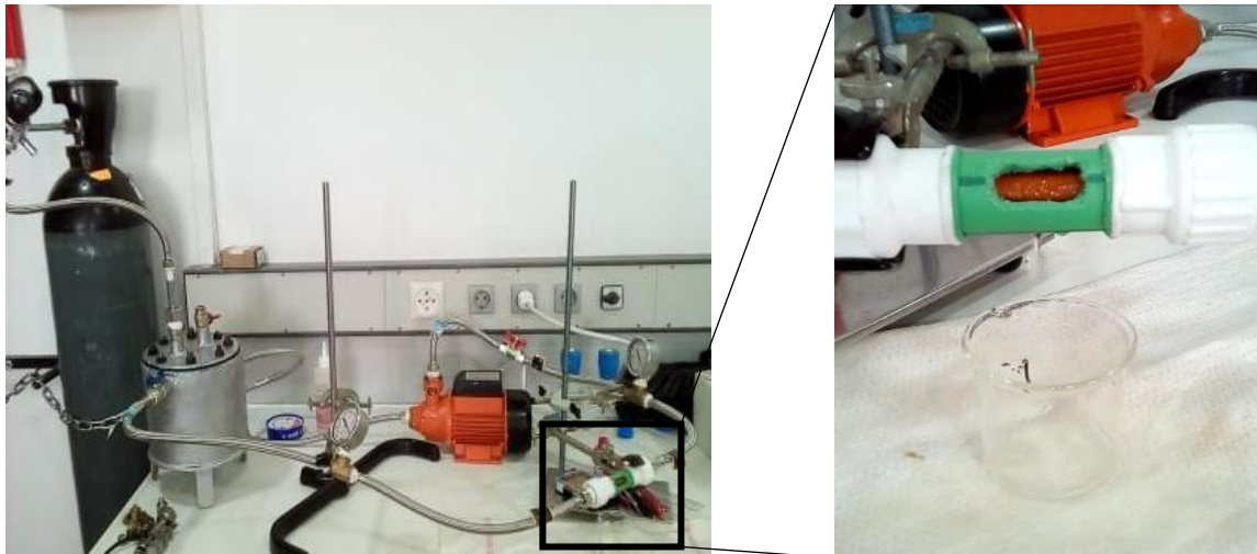
Figure III. 5 Installation pilote de filtration tangentielle et recueil du perméat
