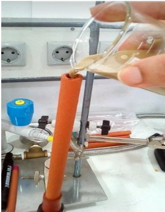
Figure III. 6 Dépôt de la membrane
