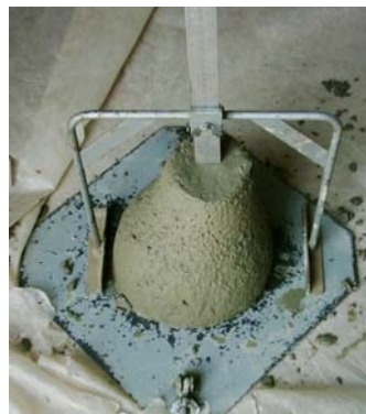
Figure 6.13 : Mesure de l'affaissement du béton
