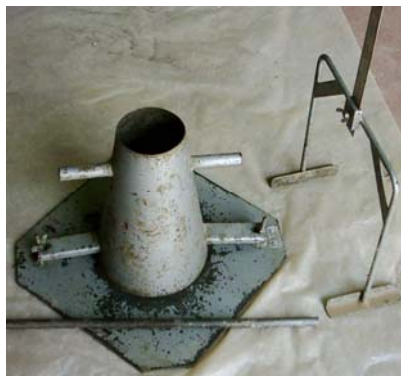
Figure 6.13 : Mesure de l'affaissement du béton
