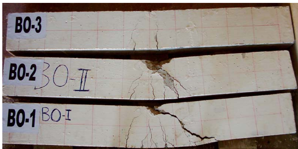
Figure7.5 (a) : poutres en Béton Ordinaire (BO).
