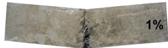
Figure 6.4 : Fissuration en BHP avec ajout des fibres d'acier (couture d'une fissure) [51].
