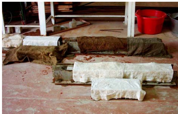
Figure 6.17 : la cure du béton durant les 24 heures du coulage
