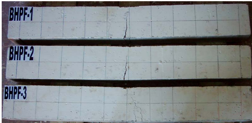
Figure7.5 (d) : poutres en Béton à Haute Performance Fibré (BHPF).
