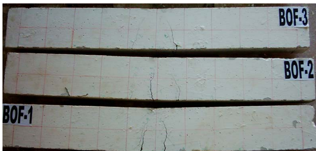
Figure7.5 (b) : poutres en Béton Ordinaire Fibré (BOF).
