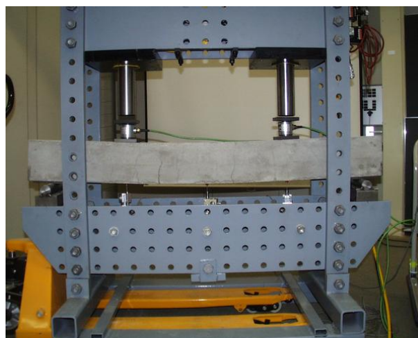
Figure 1.2 : Essai de flexion quatre points [50].
