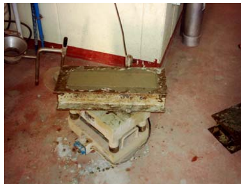
Figure 6.15 : Serrage des éprouvettes cubiques
