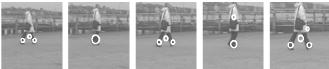
Figure 1.15 : Détection des points d'intérêts dans une séquence d'image [LAP 05].
