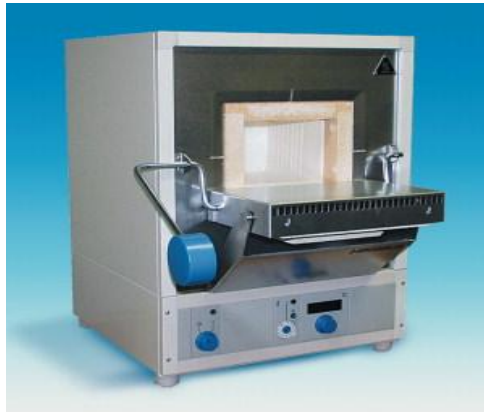
Photo IV.3 : Four à moufle utilisé pour la carbonisation du charbon actif
