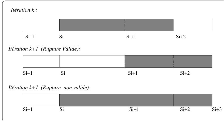
FIG. 2.7 – raffinement de la précision de détection des instants de ruptures par le critère BIC
