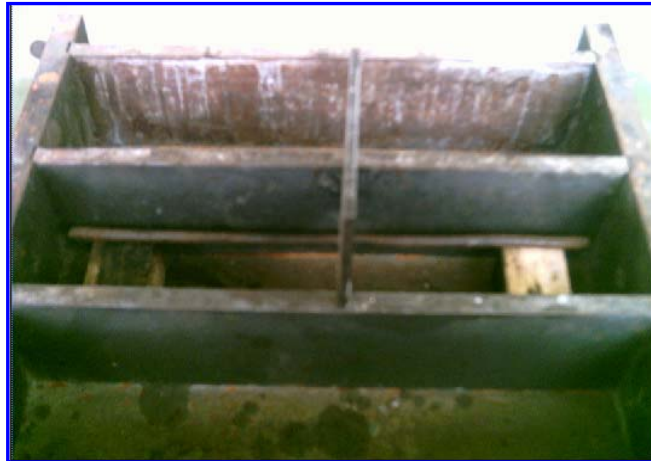
Figure III.2 : Epreuve (7.7.28) \text{ cm}^3 mise en place des Barres et entaille.
