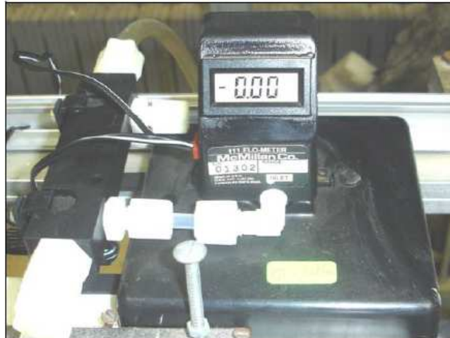
Figure 2.10 : Débitmètre à turbine.
