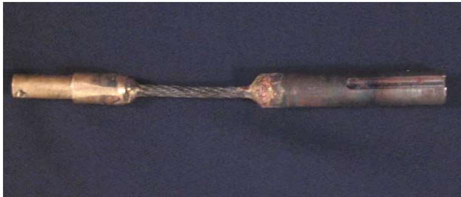
Photographie V-3 : Accouplement de transmission de mouvement.
