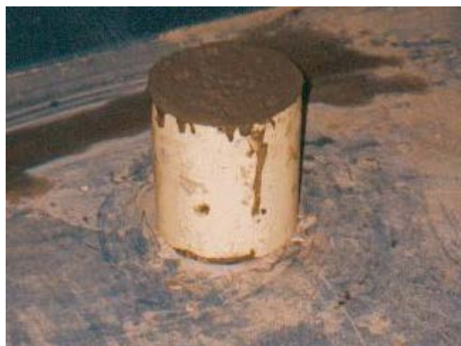
Fig 4 : Absence du phénomène de ressuage en présence des CSF
