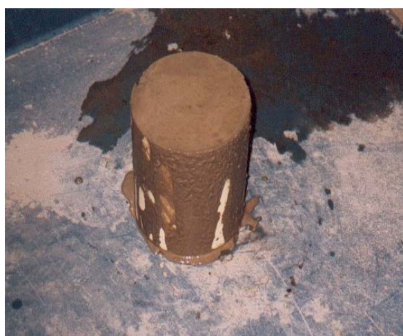
Fig 3 : Phénomène de ressuage en absence des CSF
