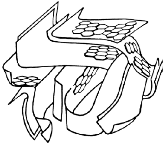
Figure 2 : Représentation schématique de la microstructure d'un charbon actif d'après A.Oberlin [1]
