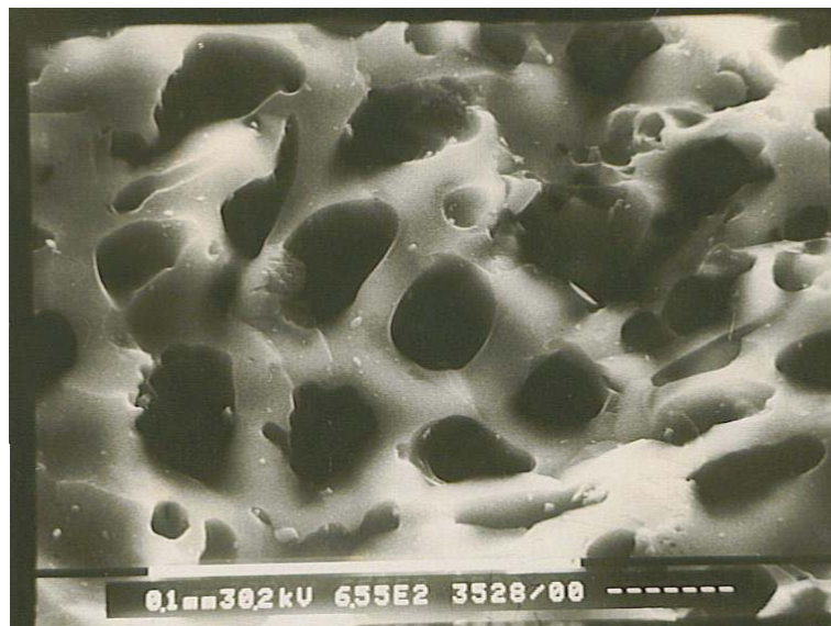
Figure 3 : Photo SEM du charbon actif DK à 800 °C
