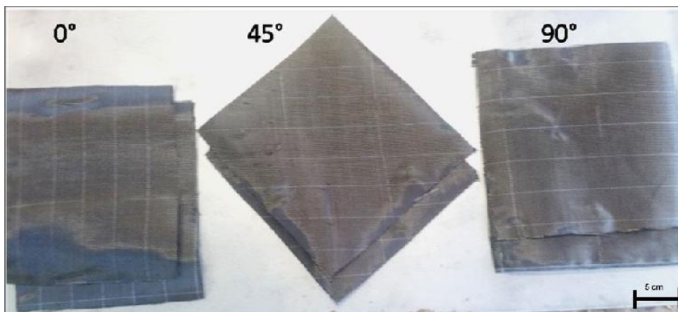
Figure II.14 Tissu de carbone à l'orientation de (0^\circ / 45^\circ / 90^\circ)
