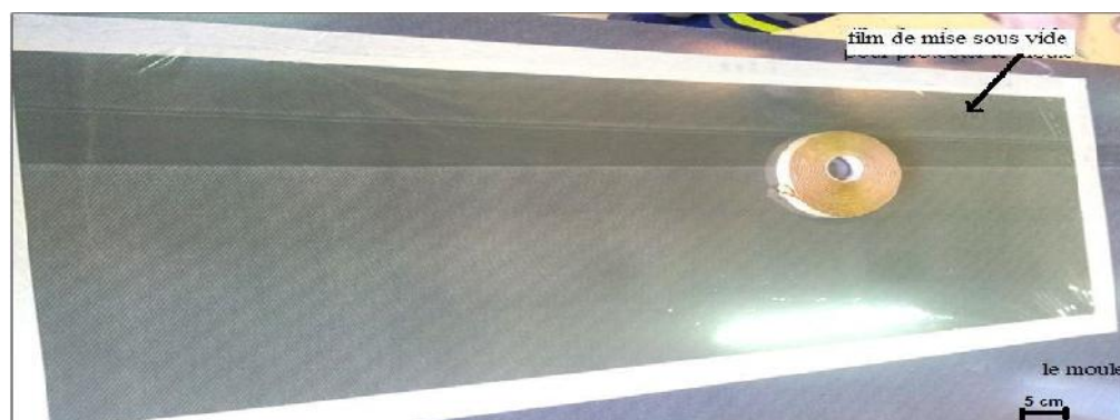
Figure II.10 Protection de moule par film de mise sous vide
