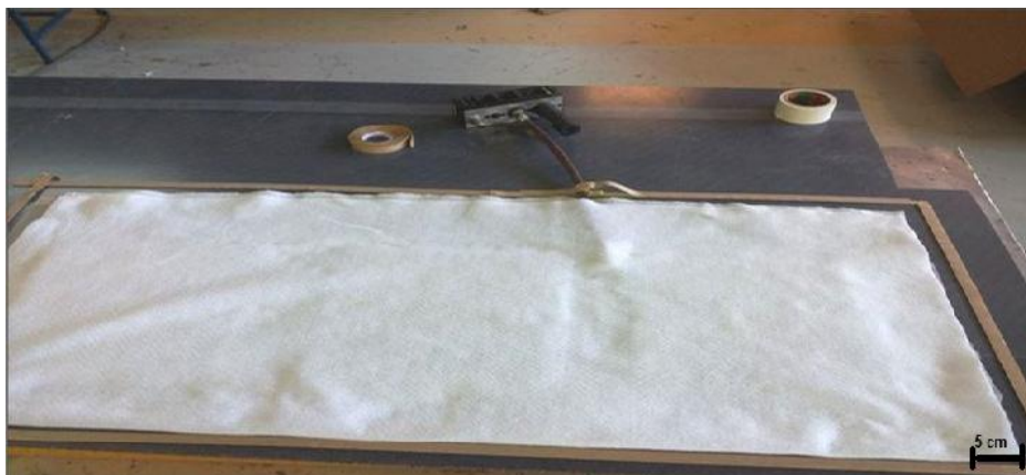
Figure II.18 Installation et dépôt de différents tissus
