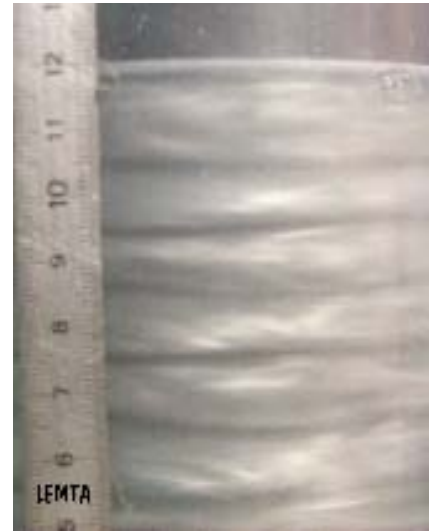
\Gamma = 12 ; Ta = 380 -Régimes d'ondes azimutales -Début de torsades à la surface
