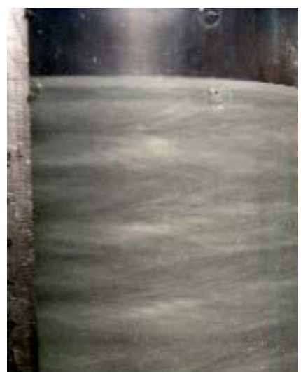
\Gamma = 12 ; Ta = 1800 Écoulement turbulent
