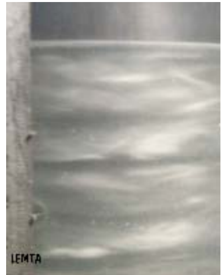
\Gamma = 16 ; Ta = 380 - Régimes d'ondes azimutales - Début de torsades à la surface
