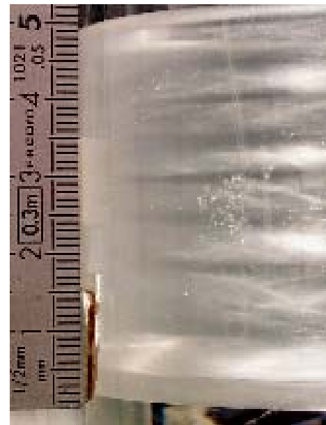
\Gamma = 8,33 ; Ta = 1090 Régime turbulent
