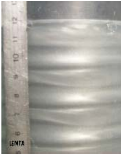
\Gamma = 12 ; Ta = 153 Régime d'ondes azimutales
