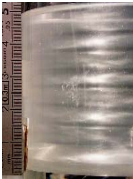
\Gamma = 8,33 ; Ta = 607 Torsades sur toutes les cellules Régime chaotique
