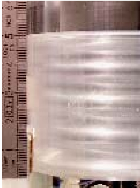
\Gamma = 8,33 ; Ta = 273 Absence d'onde azimutale
