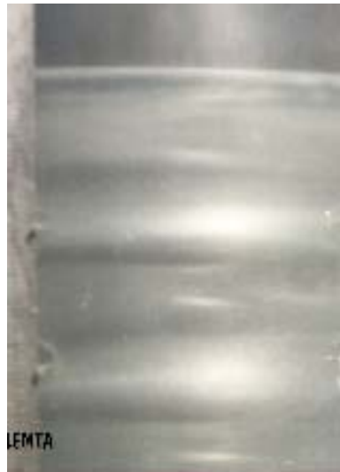
\Gamma = 16 ; Ta = 95 Début du régime d'ondes azimutales
