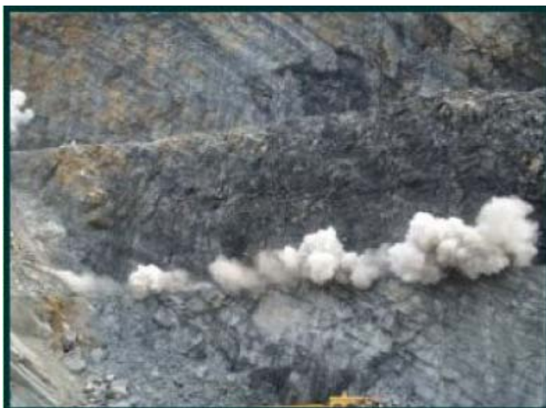
Photo I.4. Explosion sur un front.
