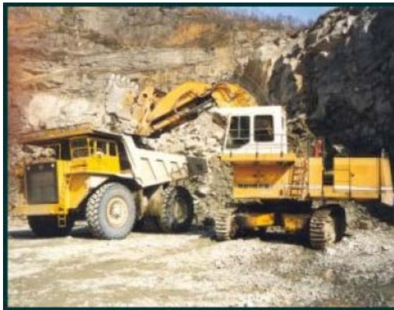
Photo I.7. Chargement d'un Tombereau pour l'usine.
