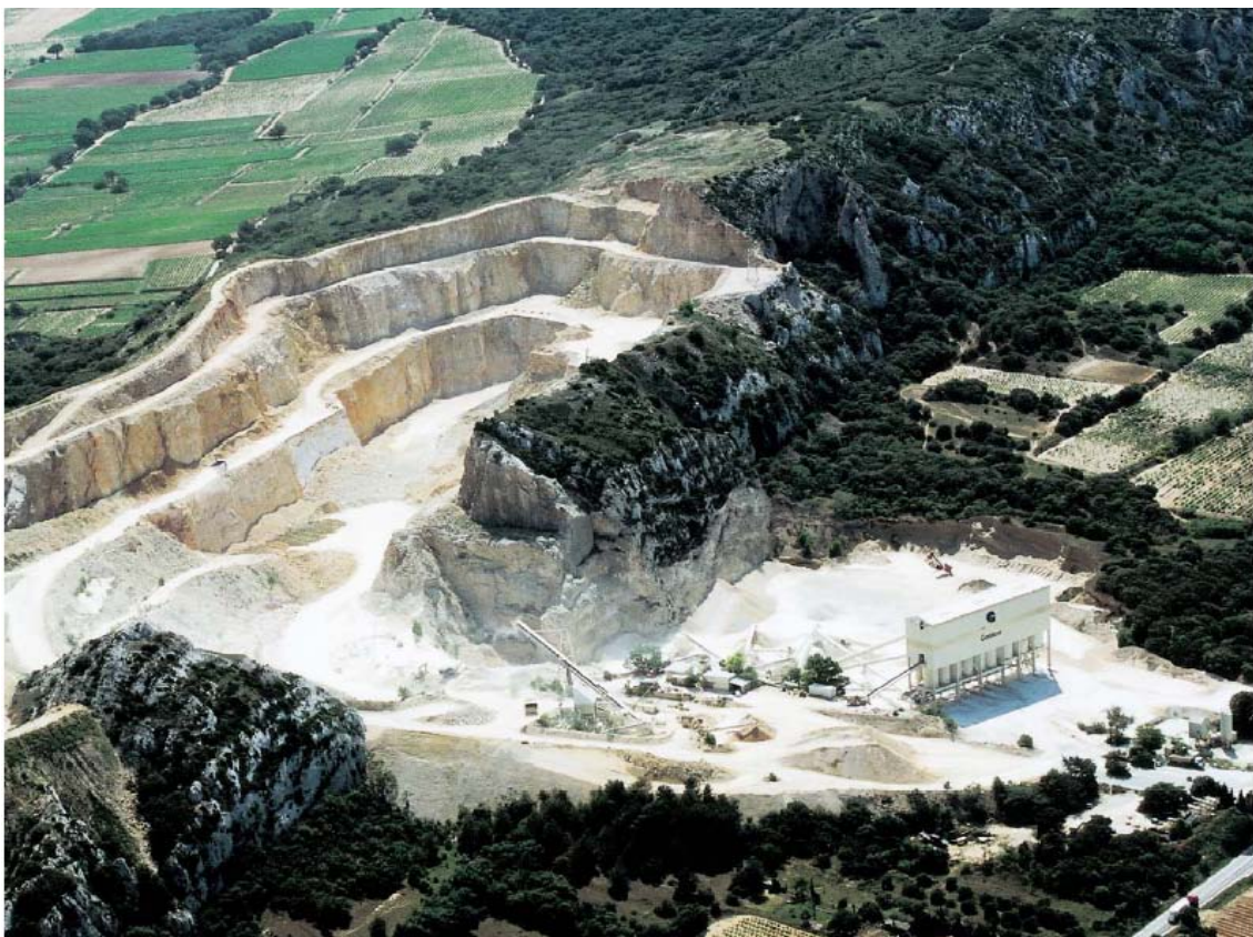
Photo I.1.: Extraction par gradin.
