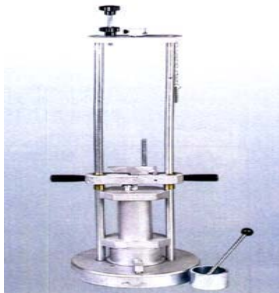
Figure II.5. Machine pour la fragmentation dynamique.
