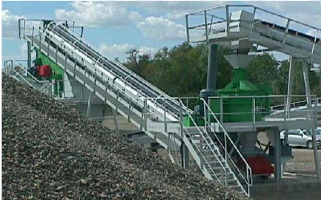
Photo I.9 : Broyeur pour broyage secondaire et tertiaire
