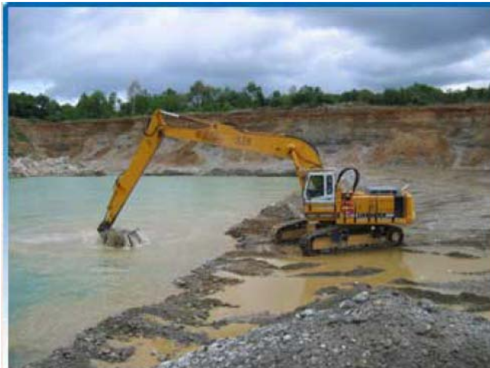
Photo I.2. Extraction des granulats alluvionnaires.
