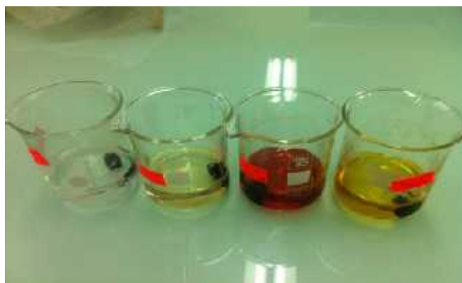
Figure V.8 : Changement de couleur des échantillons immergés dans différentes bases.
