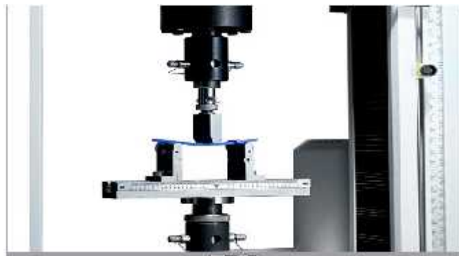
Figure IV.5 : appareil de test de trois points.
