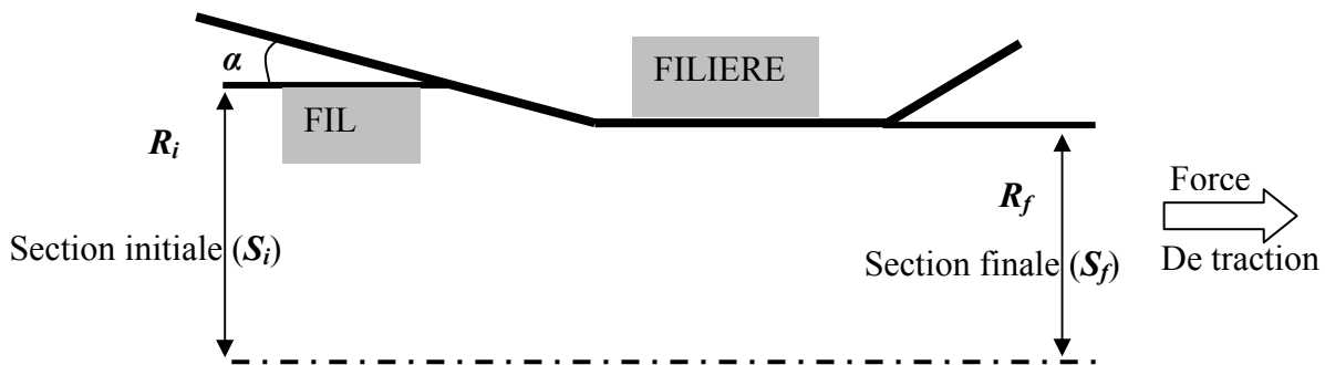
Figure I.5 : Schéma d'une passe de tréfilage
