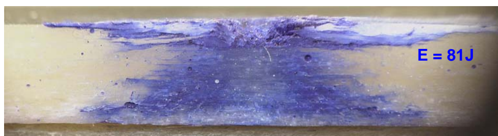
Figure : III.5 : Photos représentatives des fissurations interlaminaires à travers plusieurs interfaces
