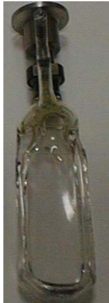
Fig. 59. Photographie de la déformation des ampoules en pyrex sous l'effet de la température.
