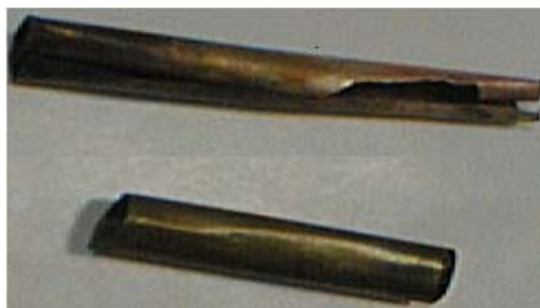
Fig. 42. Photographie de l'érosion de la cathode en clinquant, lors d'une manipulation.
