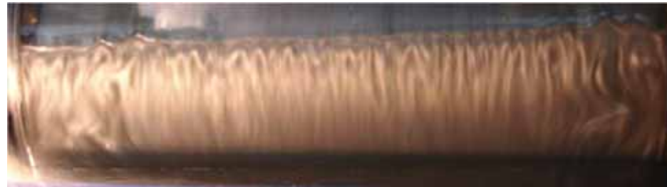
Figure III-47 : Effet de inclinaison sur l'écoulement de Taylor-Couette à Ta=150 pour \Gamma=19 (vue derrière).
