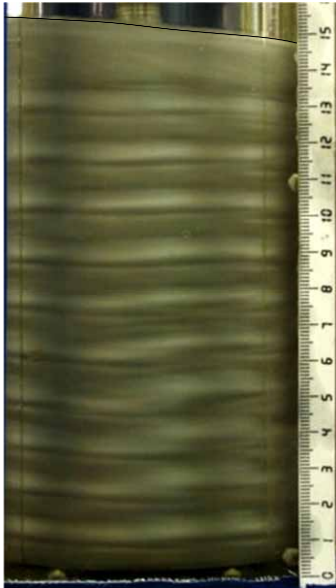
Figure III-38: Régime de fluctuations et mise en évidence de la topologie de la surface libre à Ta=400 pour \Gamma=31
