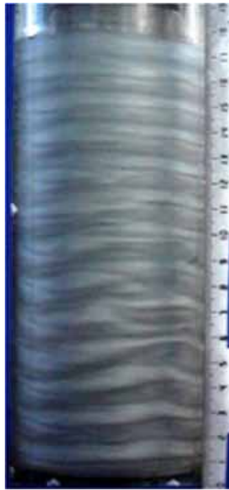
Figure III. 27 : Surface libre ondulée et taille de la cellule proche de la surface libre en augmentation.
