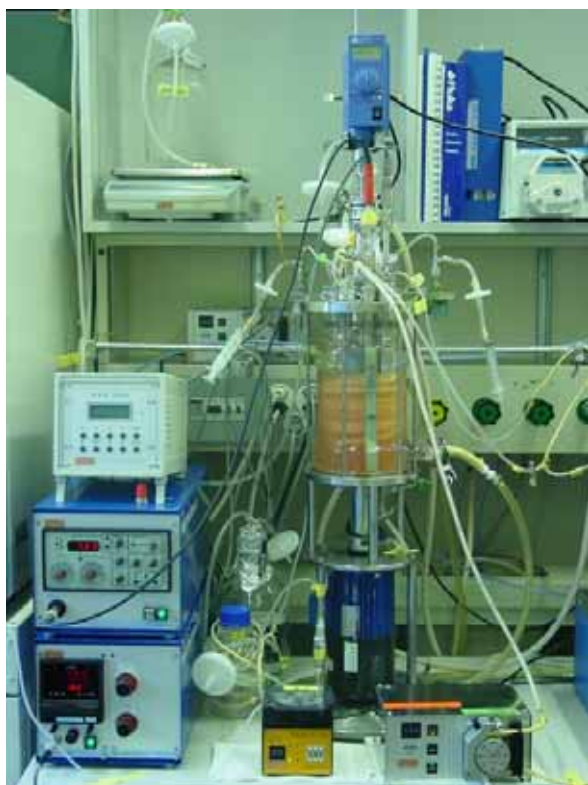
Figure I.21: Culture de cellules mammifères effectuée dans un bioréacteur de laboratoire (2 litres). Les pompes péristaltiques visibles en bas servent à alimenter le milieu de culture ainsi qu'à l'addition de base pour le contrôle du pH. Les boîtiers à gauche servent à l'acquisition des signaux. [119]
