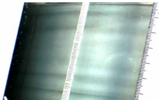
Figure III.21 : Observation des ondes évanescents à \alpha=10^\circ et Ta=44
