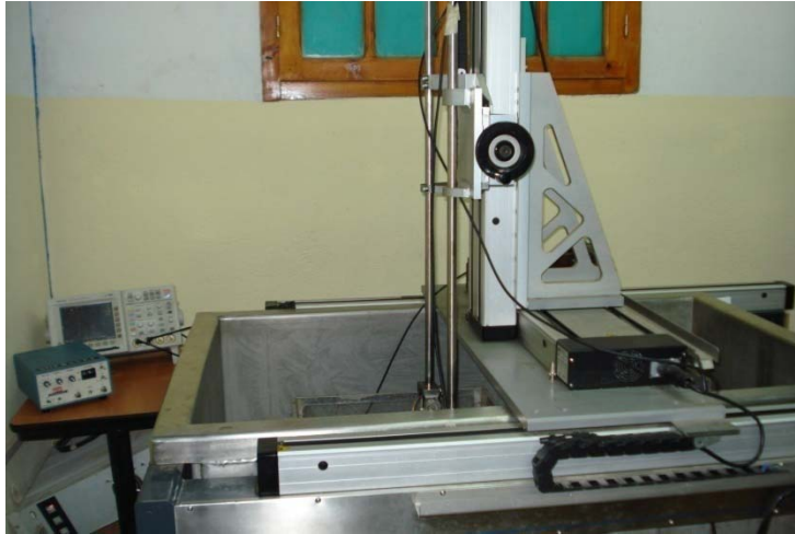
Figure 5.3: La cuve à ultrasons, l'oscilloscope et le générateur-récepteur utilisés pour l'acquisition des signaux A-scan.
