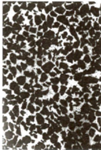
Figure I.3 : Sable de Fontainebleau (Phase solide en noir et espace des pores en blanc)
