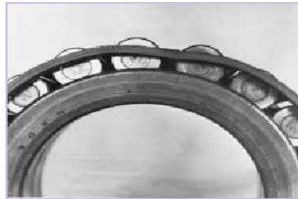
Figure 2.9 Détérioration des cages.
