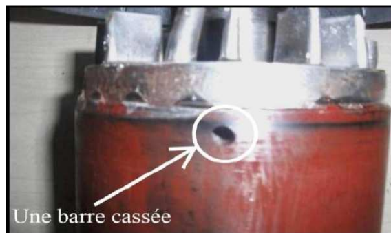
Figure I.3: Défaut d'une barre cassée.
