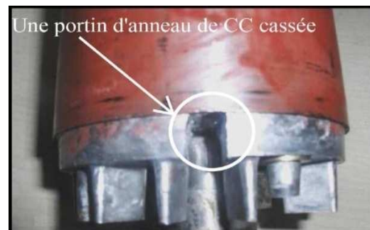
d) Rotor avec une portion d'anneau cassée.
