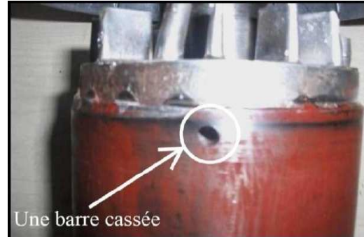
b) Rotor avec une barre cassée.
