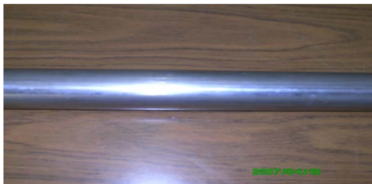
Figure 2 : Un tube en acier inoxydable de diamètre externe 40 mm et d'épaisseur de 1,6mm servant de guide d'ondes.
