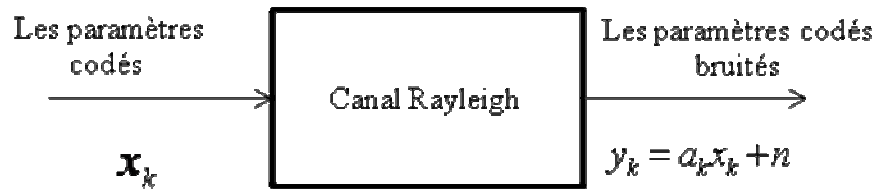
Figure 3.12 Simulation du canal avec canal Rayleigh
