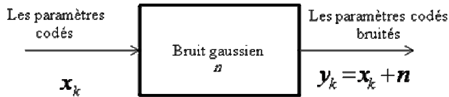
Figure 3.11 Simulation du canal avec bruit gaussien
